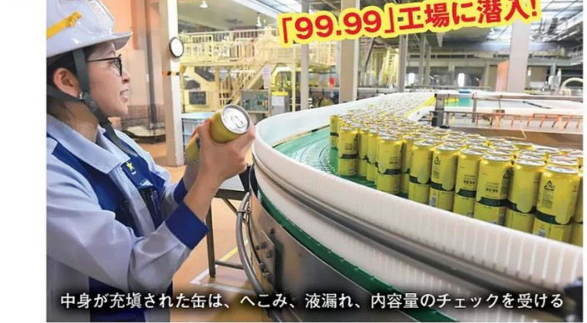
「99.99」工場に潜入！ 中身が充填された缶は、へこみ、液漏れ、内容量のチェックを受ける
